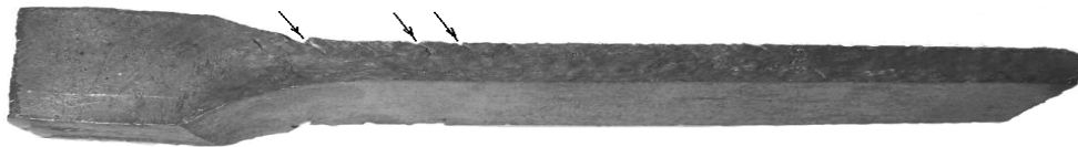
Рис. 4. Образец сурьмянистого (PbC1 + 2,5 % Sb) свинца, прокатанный со свободным уширением
