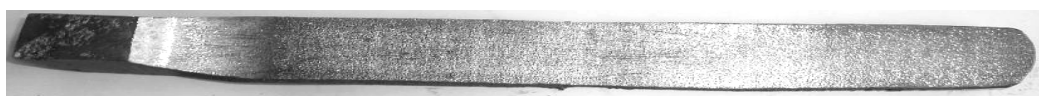
Рис. 3. Внешний вид образца ( H \times B = 26 \times 20 мм) технического чистого свинца С1, прокатанного со степенью деформации \varepsilon = 72 %
